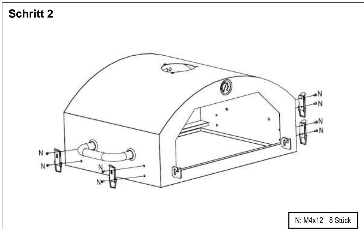
Montieren Sie die Spannverschlüsse (P6) wie gezeigt an das Gehäuse.
