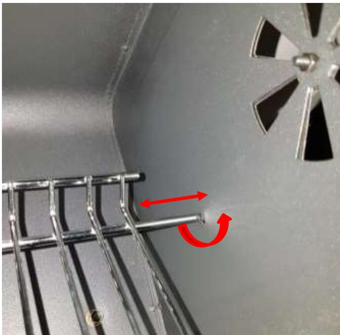
Drehen Sie den Rost, bis die Nasen ein Hin- und Herschieben ermöglichen. Anschließend können Sie Warmhalterost aus dem Deckel nehmen.
