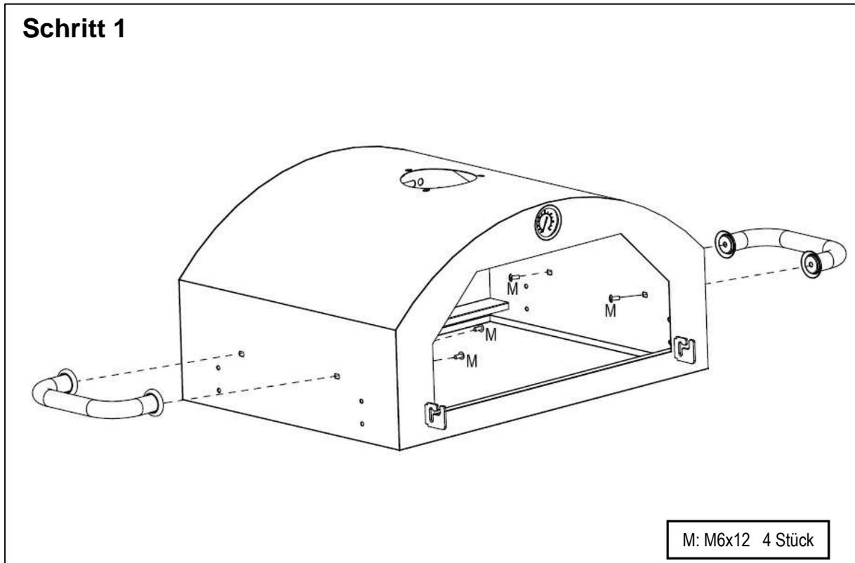
Schrauben Sie die beiden Griffe (P4) seitlich an das Ofengehäuse.
