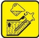
Hier befindet sich die Öleinfüllöffnung. Bis zum dargestellten Niveau auffüllen.
