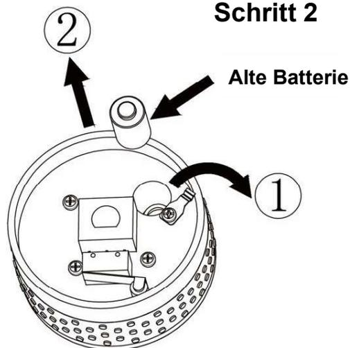
Schwenken Sie zuerst die Federklammer zur Seite und entnehmen Sie dann die alte Batterie.
