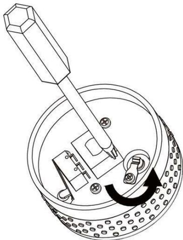
Ziehen Sie den Regulierknopf ab. Lösen Sie mit dem Schraubendreher leicht die Federklammer.
