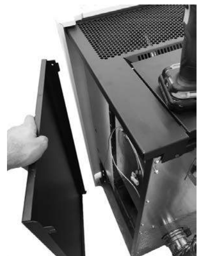
Fig. 22 - Entfernen der Seiten
