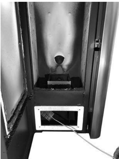
Fig. 32 - Mit einer Rohrreinigungsbürste reinigen
