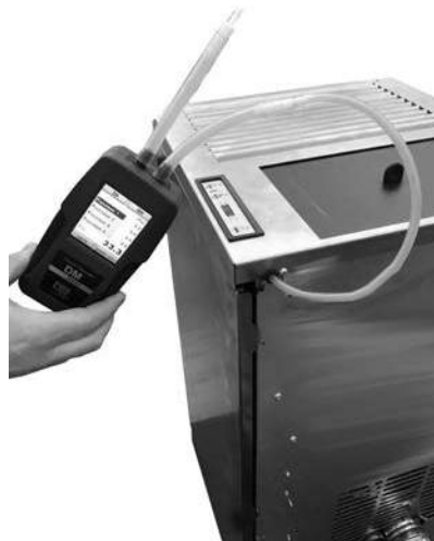
Fig. 26 - Anschluss des Digitaldruckwächters
