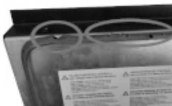
Fig. 24 - Verschlechterte Dichtung
