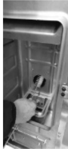
**Fig. 41 - Reinigung mit Flaschenbürste**
