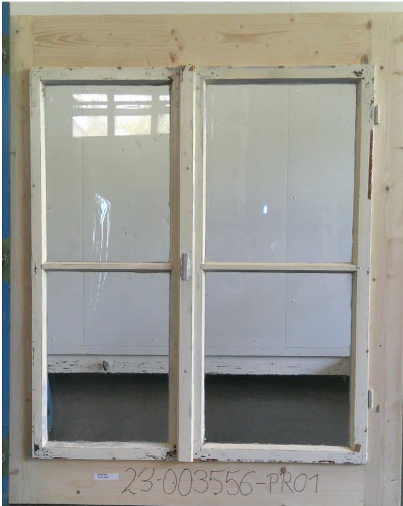
Bild 5 Foto des Probekörpers (Ansicht Innenseite Fenster)
