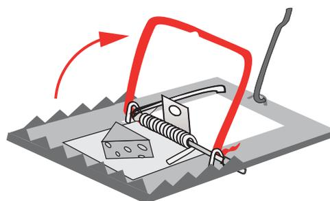
3. Halten Sie den Schnappbügel gut heruntergedrückt und legen Sie den Haltedraht so in die Öse, dass er gerade so drinsteckt, um ein empfindliches Auslösen der Falle zu garantieren.
