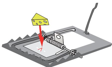
2. Schnappbügel vorsichtig spannen. Hierbei unbedingt darauf achten, dass die Finger sich beim Spannen zu keinem Zeitpunkt auf der Bodenplatte unter dem Bügel befinden.
