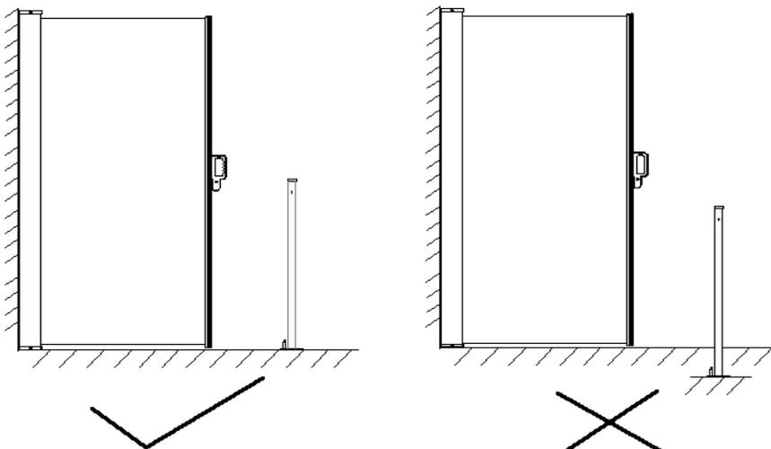
6. Bohren Sie nun mit einem 10mm Bohrer ca. 6cm tiefe Löcher in den Boden und führen die Dübel bündig ein, Sie können zur Hilfe einen Gummihammer benutzen. Befestigen Sie nun den Markisenanker mittels der Schrauben M6x60mm am Boden.
