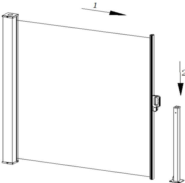
2. Zum Schließen der Markise Halten Sie den Griff, und heben diesen nach oben. Dann wird die Torsionsfeder im Inneren der Kassette sofort freigegeben, und das Gewebe geht automatisch zurück. Halten Sie die vordere Stange senkrecht und lassen Sie diese langsam zusammen mit dem Gewebe in Richtung Kassette einziehen.
