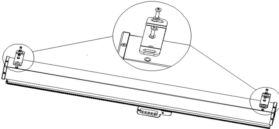
Befestigung der Klammern an der Kassette mit einem Kreuzschraubendreher. Die Schrauben und Unterlegscheiben sind im Zubehör enthalten.
