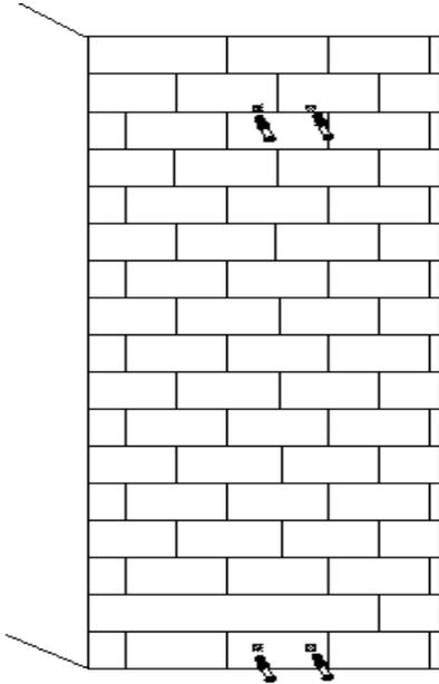
4. Befestigen Sie nun die Kassette mittels der Schrauben M6x60mm an der Wand.
