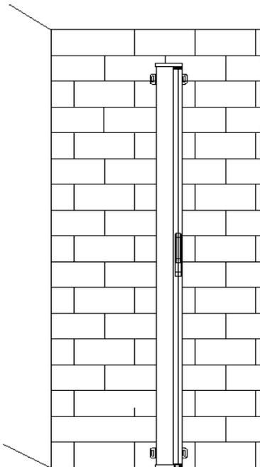
3. Bohren Sie mit einem 10mm Bohrer ca. 6cm tiefe Löcher zur Befestigung der Wandhalter in die Wand. Führen Sie die Dübel bündig in die Bohrlöcher, Sie können zur Hilfe einen Gummihammer nutzen
