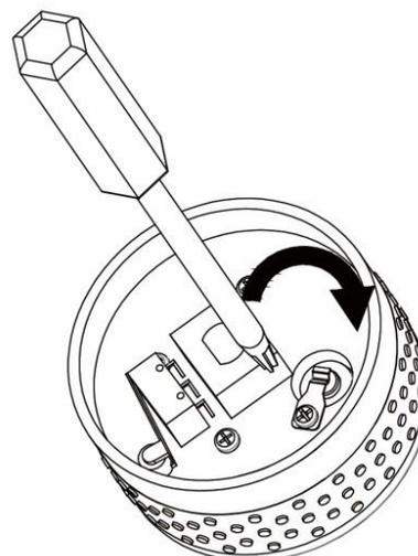
Mit dem Schraubendreher ziehen Sie die Federklammer wieder fest. Achten Sie dabei darauf, dass die Klammer auf der Batterie verbleibt.
