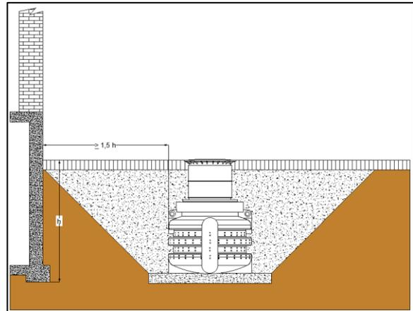
Die Böschung ist nach DIN 4124 anzulegen. Der Baugrund muss waagrecht und eben sein und eine ausreichende Tragfähigkeit gewährleisten.
