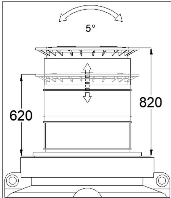
Zwischen dem minimalen und maximalen Wert ist der Dom stufenlos verschiebbar.
