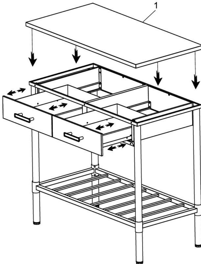
8. Zum Ausrichten der Schubladenblende (Bauteil 10) lösen Sie die Verschraubung der Handgriffe und richten die Blenden aus. Ziehen Sie die Verschraubung dann wieder an.
