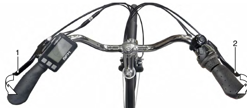
Handbremshebel (1) für Vorderradbremse
