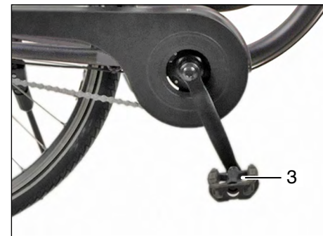
Pedal (3) für Hinterradbremse mit Rücktrittbremse
