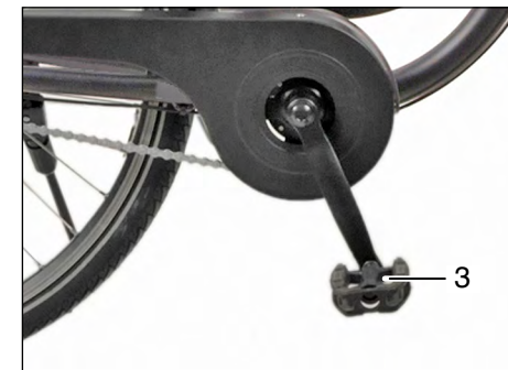
Pedal (3) für Hinterradbremse mit Rücktrittbremse
