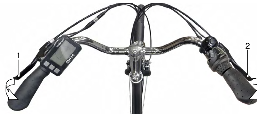
Handbremshebel (1) für Vorderradbremse
