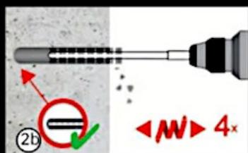
Bohrloch mit geeigneter Drahtbürste mittels eines Akkuschraubers oder Bohrmaschine ausbürsten.
