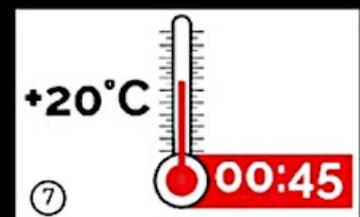
Die angegebene Aushärtezeit muss eingehalten werden. Anker während der Aushärtezeit nicht belasten.
