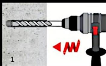
Bohrloch drehschlagend mit vorgeschriebenem Bohrerdurchmesser und gewählter Bohrlochtiefe erstellen.
