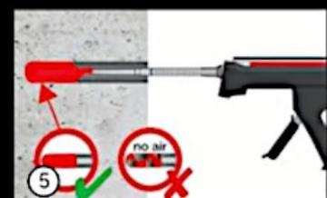
Gereinigtes Bohrloch vom Bohrlochgrund her ca. zu 2/3 mit Verbundmörtel befüllen. Für Setztiefen größer 190mm passende Mischerverlängerung verwenden.
