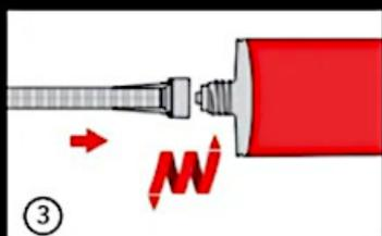
Schraubkappe und falls vorhanden Schlauchfolienclip entfernen. Statikmischer aufschrauben.
