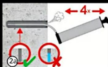
Bohrloch mit Druckluft (min. 6 bar) oder Handpumpe ausblasen.
