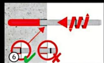
Befestigungselement mit leichten Drehbewegungen bis zur festgelegten Setztiefe einführen. Die Ankerstange muss schmutz-, fett-, und ölfrei sein.
