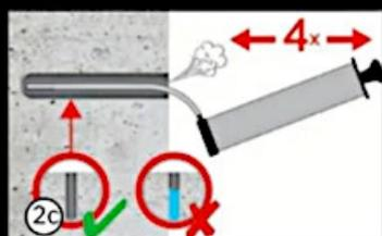
Anschließend Bohrloch erneut vom Bohrlochgrund vollständig mit Druckluft oder Handpumpe ausblasen.
