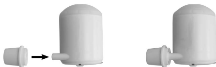
Bild 2: Adapter auf Pumpausgang aufstecken
