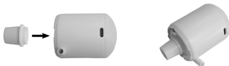
Figure 4 : Placer l'adaptateur sur l'ouverture d'aspiration
