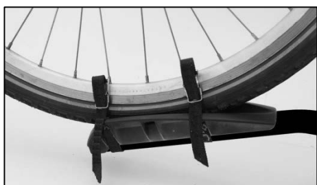
Figure 16 : Sangles de sécurité de la roue avant
