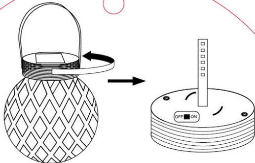
1. An der Unterseite befindet sich ein 'ON/OFF'-Schalter. Schieben Sie ihn auf 'ON'!
