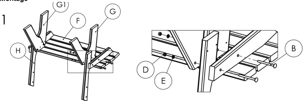
Befestigen Sie die Fussteile G und G1 sowie die Halterungen für das Rückenteil mit den Schloss-Schrauben B wie abgebildet am Sitzteil der Bank.
