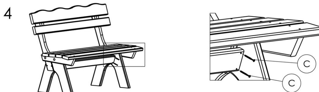
Befestigen Sie die Querstrebe J mit den Holzschrauben C zwischen den Füßen Der Bank.
