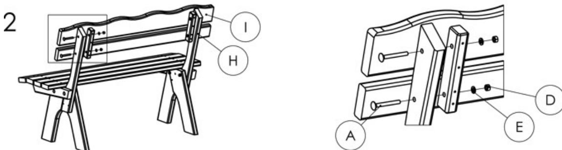
Befestigen Sie das Rückenteil I wie abgebildet mit den Schloss-Schrauben A an den entsprechenden Halterungen H für das Rückenteil.
